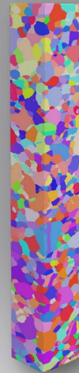
316L steel, cubic,  $4.4\times 0.7\times 0.7$  mm
